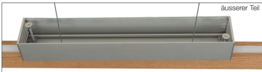
Nun können Sie die Liftfunktion testen und den Holzkörper nach oben oder nach unten bewegen. Die Leuchte bleibt dabei in der gewünschten Position stehen. Bewegt sich die Leuchte selbständig nach unten oder ist Sie blockiert, müssen die Seilrollen stärker angezogen oder gelöst werden (die beiden Rollen müssen separat eingestellt werden). Die Einstellung erfolgt manuell und benötigt kein Werkzeug.
