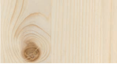
F Astfichte mit Wasserlack behandelt abete trattato con vernice all'acqua spruce coated with a water varnish
